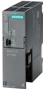
SIMATIC S7-300 CPU 317-2 PN/DP, Módulo central con memoria de trabajo de 1 MB, 1.<sup>a</sup> interfaz MPI/DP 12 Mbits/s, 2.<sup>a</sup> interfaz Ethernet PROFINET, con switch de 2 puertos, Se necesita Micro Memory Card
