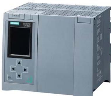
SIMATIC S7-1500F, CPU 1518F-4 PN/DP, módulo central con memoria de trabajo de 9 MB para programa y 60 MB para datos, 1.ª interfaz: PROFINET IRT con switch de 2 puertos, 2.ª interfaz: PROFINET RT, 3.ª interfaz: PROFINET servicios básicos, 4.ª interfaz: PROFIBUS, 1 NS rendimiento bits, se necesita SIMATIC Memory Card
